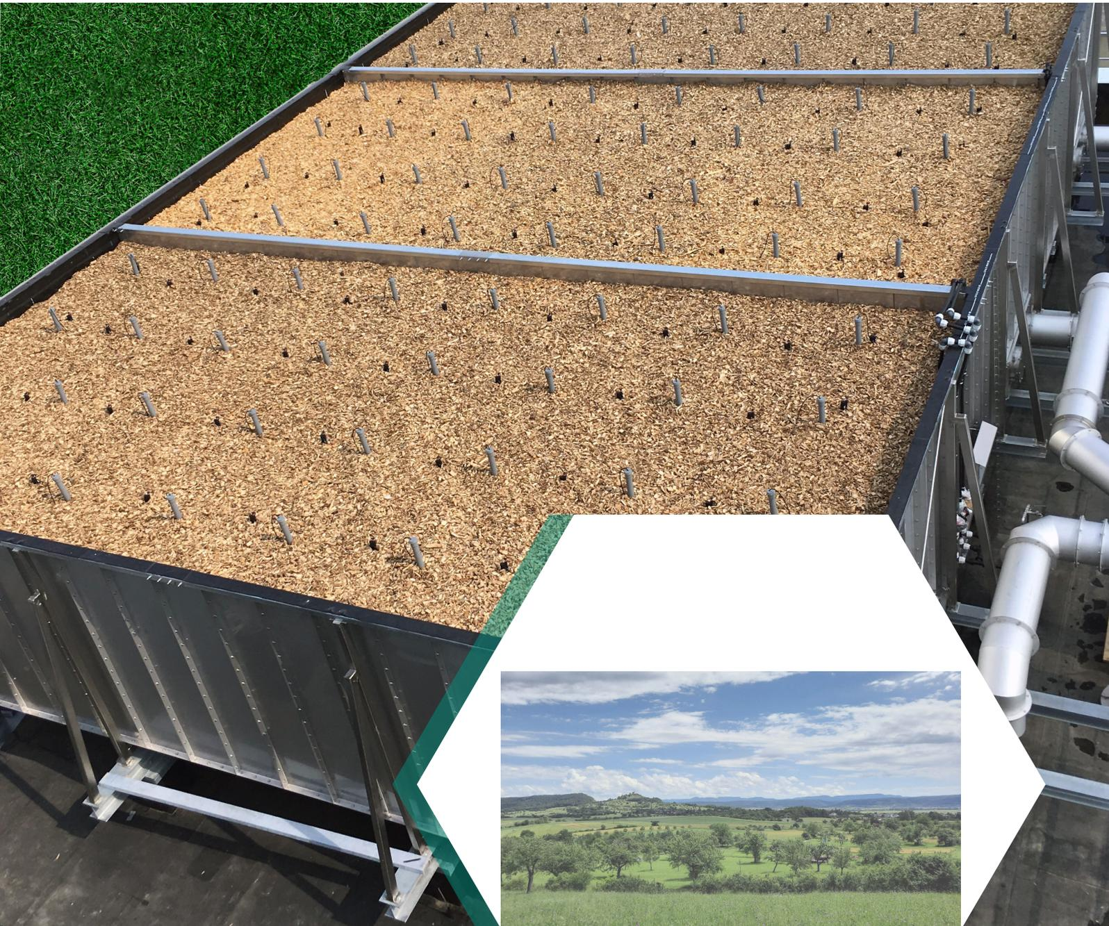
Diese innovative Lösung nutzt die biologischen Prozesse der Natur, sogenannte Mikroorganismen, um Schadstoffe und Gerüche aus Abgasen zu entfernen. Verabschieden Sie sich von Gasbrennern oder Wasserwaschanlagen. Entscheiden Sie sich für Nachhaltigkeit und frische Luft mit dem **ECO AIRCLEAN F**.
