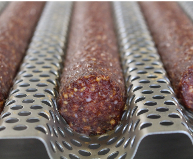
Abb.1: Kammereinsicht, Produkt darmlose Salami, liegend in Muldenblechen
